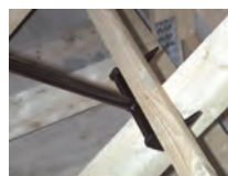
Lattenheber speziell für Renovierungsarbeiten, äußerst widerstandsfähig, müheloses Entfernen alter Lattungen
