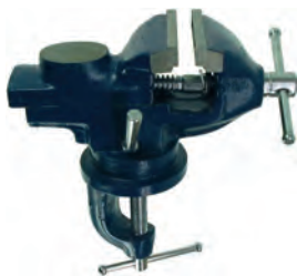
Präz.-Parallel-Schraubstock mit gehärteten Stahlbacken und Prismenführung, drehbar, maximale Plattenstärke für Tischbefestigung 45 mm.
