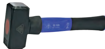
Fäustel Stiel mit 3-Komponenten-Technik und angeschmiedetem Stielschutzkragen und Schutzhülse - Aluminium-Seele - Polyamid-Komponente, blau - Griff aus rutschfestem Kautschuk unzerstörbar, vibrationsfrei, ergonomisch
