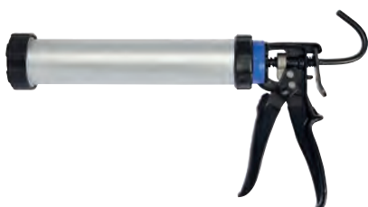
Kartuschen-Pressen HaWe Profi drehbares Alu-Rohr, Überwurfmutter aus Alu, gummierter Griff und Abzug, erhöhte Druckbelastbarkeit des Vorschubmechanismus, starker Schubklotz, Profischubteller für restloses Entleeren des Beutels, für hochviskose Kleb- und Dichtstoffe. Übersetzungsverhältnis 17:1 Kartonverpackt
