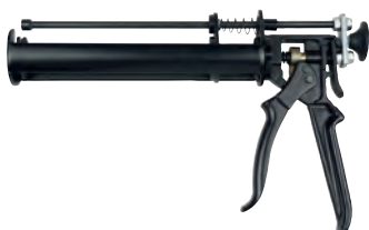
Auspresspistole für Verbundmörtel-Doppelkartuschen bis 390 ml und Einzelkartuschen bis 310 ml. Extrem robust für sehr zähe Massen. Leichtgängiges und gleichmäßiges Arbeiten. Doppelte Schubstangenführung. Übersetzungsverhältnis 25:1
